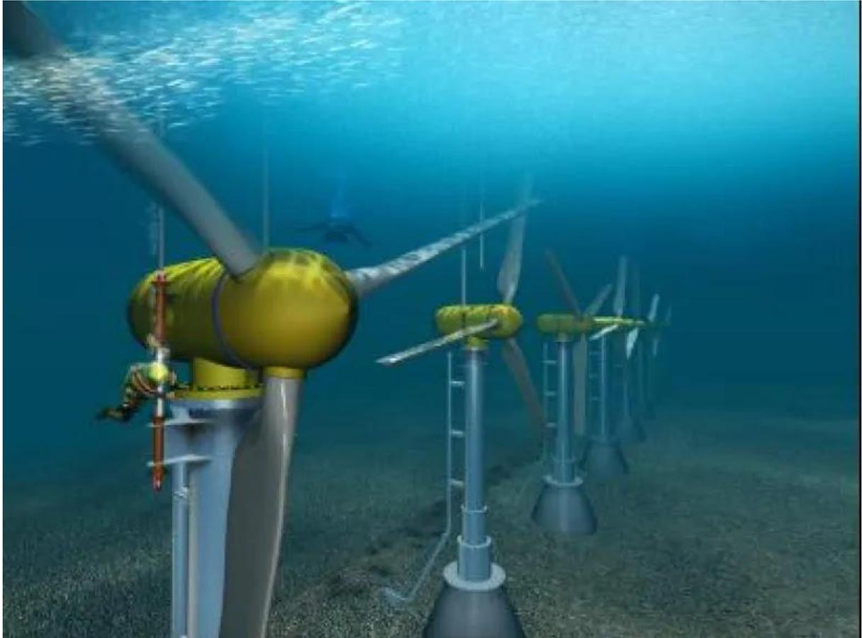
فيما تستخرج طاقة ماء البحر الكامنة والحركية والحرارية والكيميائية التي يمكن تحويلها لتوفير الكهرباء والطاقة الحرارية أو مياه شرب. وهناك طائفة عريضة من التكنولوجيات الممكنة، مثل خزانات لموجة المد، وتوربينات تحت الماء لتيارات المحيط والمد، ومحولات الحرارة لتحويل الطاقة الحرارية بالمحيطات، وتشكيلة من الأجهزة لتسخير طاقة الأمواج ومعدل تدرج الملوحة.
