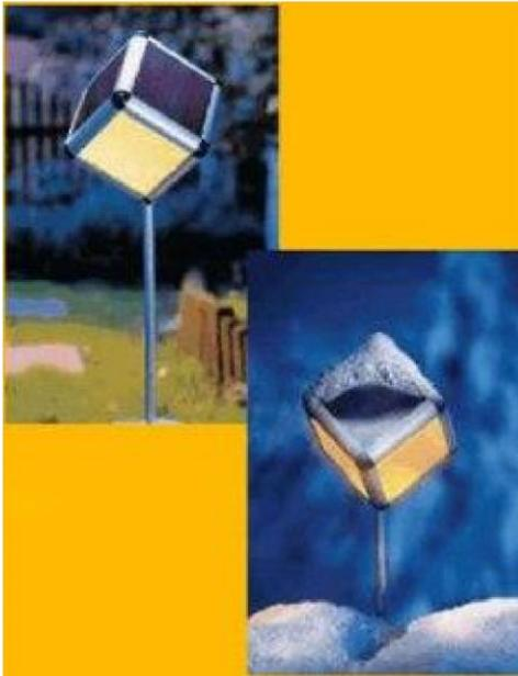
المصباح الشمسي المخصص استخدامه في الحدائق العامة أو الخاصة مجهز بثلاث شرائح شمسية قادرة علي استقطاب الأشعة الشمسية من ثلاث اتجاهات تم تقوم بتحويلها إلي طاقة كهربائية، وهذا المصباح قادرة علي العمل لمدة 10 ساعات ويعمل بطريقة ذاتية أي يفصل الدائرة الكهربائية أثناء النهار فترة تجميع الطاقة ويغلقها أثناء الليل فترة استخدام الطاقة كي يضيء المصباح.
