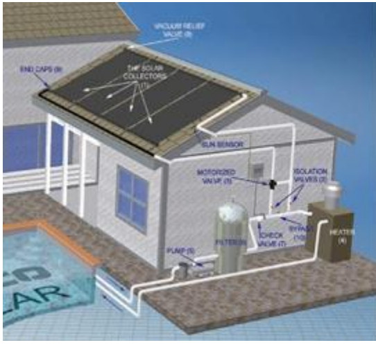
الإستفادة من الطاقة الشمسية في التسخين الشمسي للمياه
