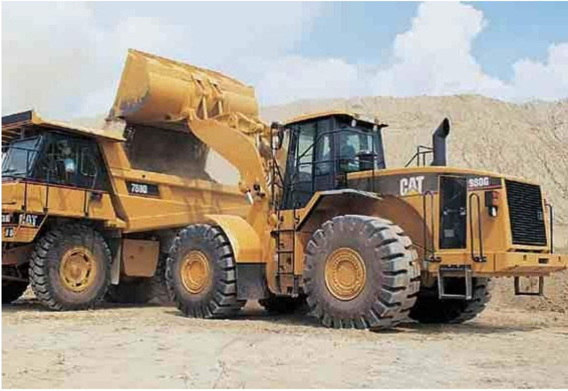
الشكل 1-1 التعدين السطحي باستخدام محمل CAT وشاحنة قلابية CAT
