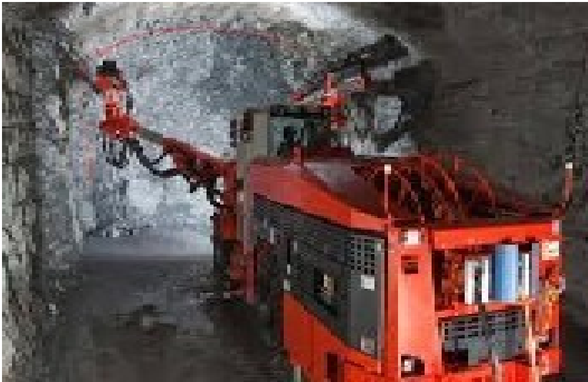
شكل (4-1): التعدين الجوفي باستخدام معدات الحفر الأفقي
