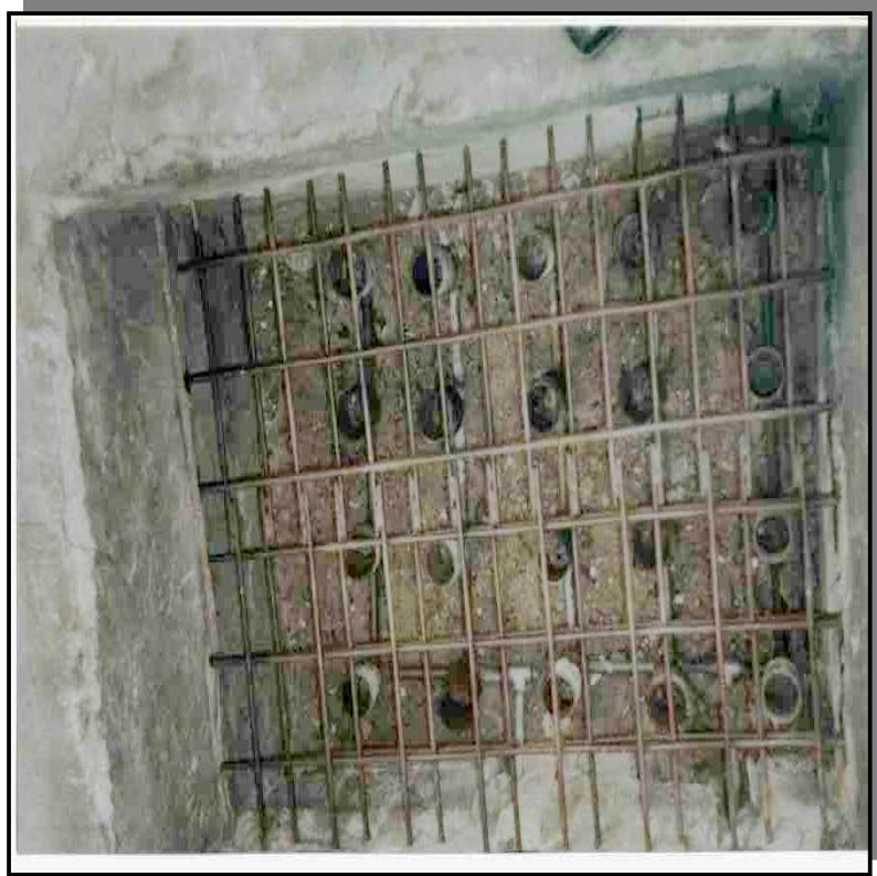
الشكل رقم [ ١ ] :- موقد من الطابوق الناري تظهر فيه شبكة المشاعل الغازية
