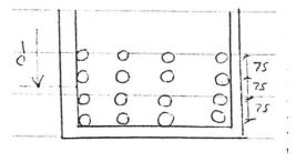
Check spacing, actual spacing =  $\frac{(500-2x40-2x12-4x32)}{3}$ =89>db o.k.
